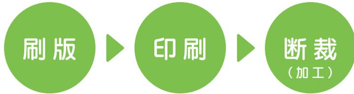
印刷用の版をつくること。CTP(アルミ版)を使用し、データを直接焼き付けます。使用後はアルミのリサイクルをしています。
